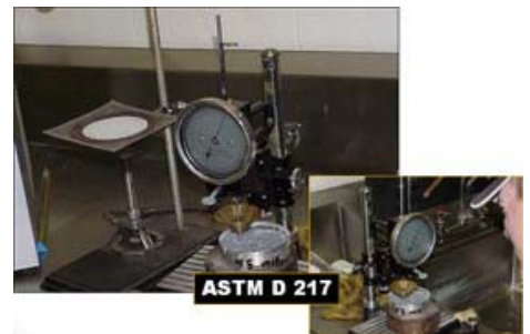
Prueba de Penetración de Cono
