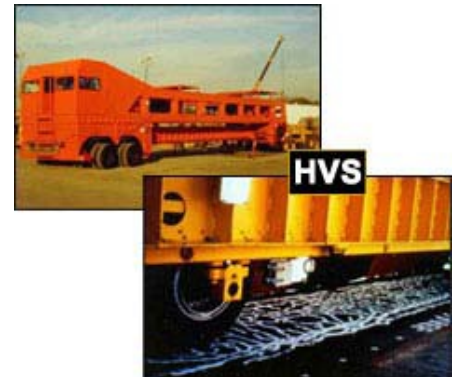
Simulador de Vehículos Pesados utilizado para la investigación de Caltrans de 1992
